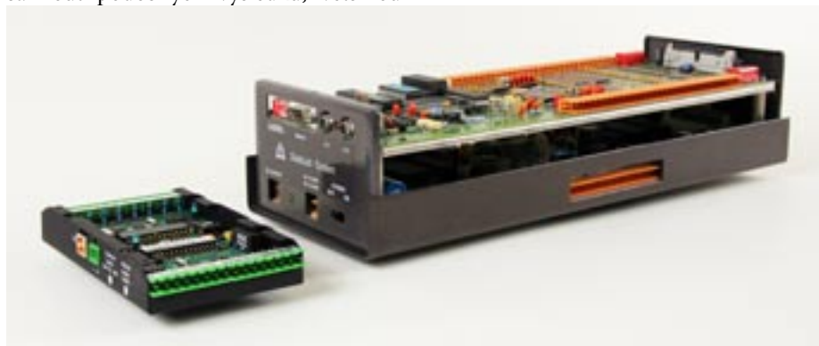
25 let evoluce – srovnání současné jednotky DataLab se svým předchůdcem se stejným počtem analogových vstupů
